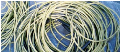
^ Lida® Piggy Back Wire Anode
